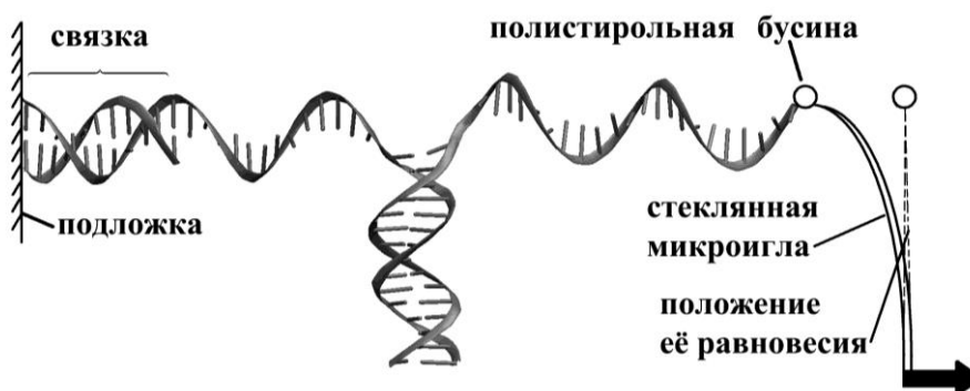
Рис. 3.2. Схематическое изображение эксперимента по «поперечной» микромеханической денатурации ДНК [230]. Объяснения см. в тексте.
