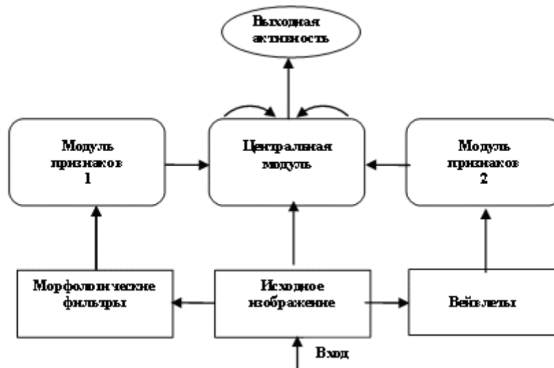
Рис. 25. Схема модели сегментации с вниманием, реализованная в виде импульсной нейронной сети [5].
